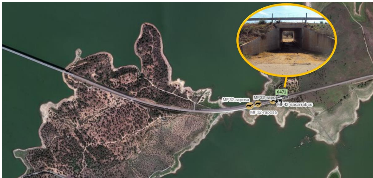
Fig. 19 – Localização do ponto negro nº 2, na EN256, com marcação dos animais atropelados e da Passagem Agrícola existente (nº 6471)
